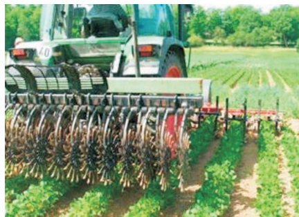
Fig. 24. Grapa rotativă (stânga) s-a dovedit a fi eficientă, în special, atunci când suprafața solului are crustă. Pentru plantele de soia mai mari se aplică, de obicei, o combinație dintre grapele cu cuțite plate și plivitorul cu deget (dreapta). La plantele mai mari de soia, se utilizează, de obicei, o combinație de măturări de găscă și de mănător de degete (dreapta)
