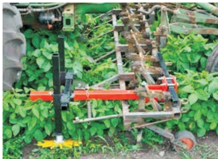
Fig. 24. Grapa rotativă (stânga) s-a dovedit a fi eficientă, în special, atunci când suprafața solului are crustă. Pentru plantele de soia mai mari se aplică, de obicei, o combinație dintre grapele cu cuțite plate și plivitorul cu deget (dreapta). La plantele mai mari de soia, se utilizează, de obicei, o combinație de măturări de găscă și de mănător de degete (dreapta)
