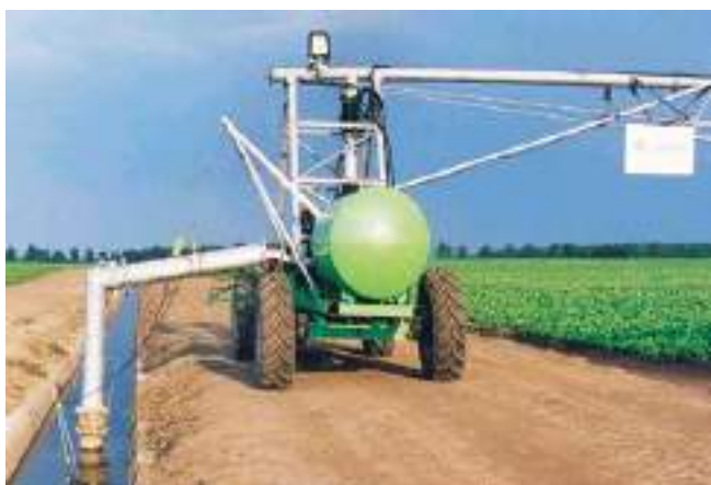
Fig. 2.4. Apa captată din canal.
