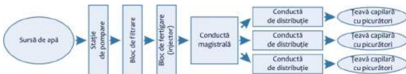
Fig. 3.1. Structura generală și principiul de lucru al sistemului de irigare prin picurare.
