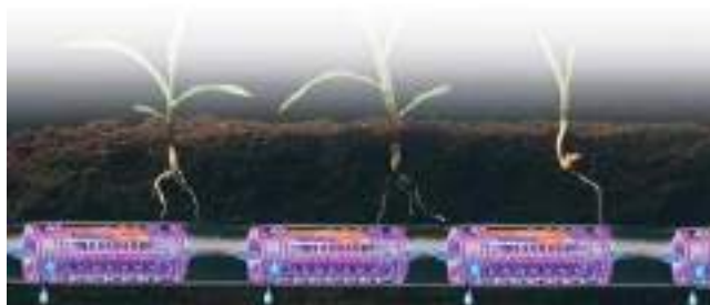
Fig. 3.20. Tub cu picurători multianuale cu compensator de presiune cu instalarea subterană.
