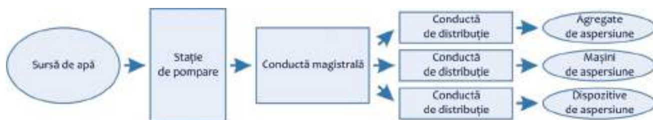
Fig. 2.1. Schema generală a sistemului de irigare prin aspersiune.
