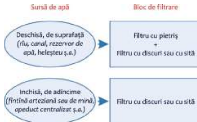
Fig. 3.4. Principalele scheme de filtrare.
