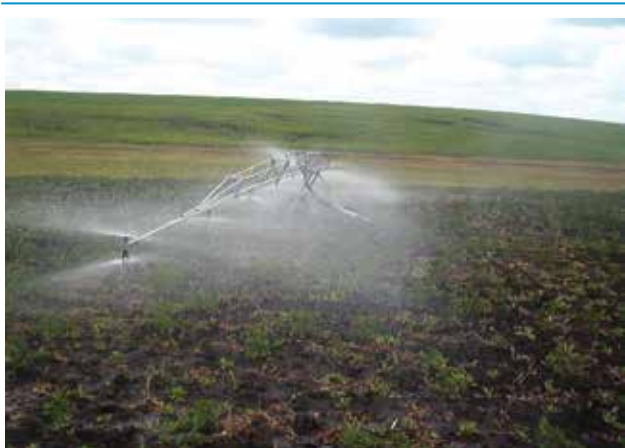
Fig. 68. Irigarea prin aspersiune cu mașină cu tambur și consolă la cultura de cartofi
