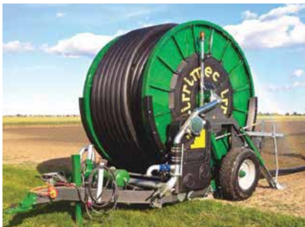
Fig. 22. Mașină mobilă de irigare prin aspersiune cu tambur
