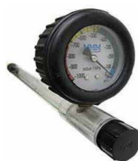
Fig. 57. Tensiometru TX cu reacție rapidă la schimbarea potențialelor de apă ale solului
