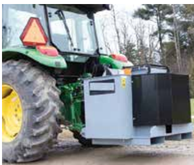
Fig. 17. Stații de pompare a apei acționate la priza de putere a tractoarelor, Sursa: https://baumalight.com/
